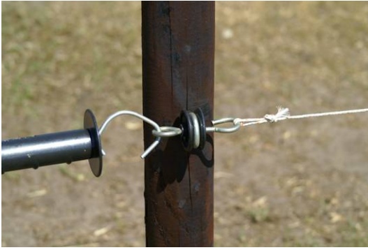
Afb. 2: Poortgrepen en poortgreepankers zorgen voor de stroomgeleiding als de poorten dicht zijn.
