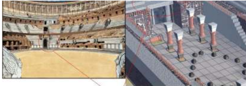
Detalhe das muretas nas laterais da arquibancada. Acompanha a inclinação. A parede acima do portal continua. Até o nível da arquibancada.
