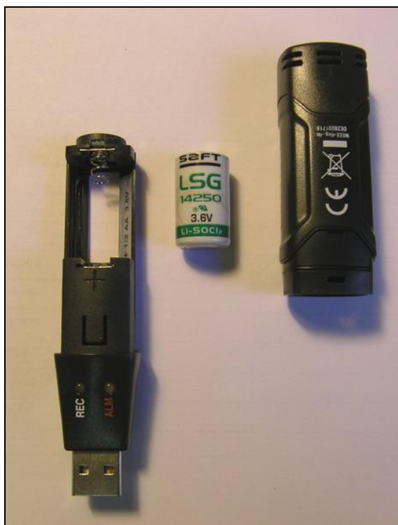
Slika 5: Razstavljen registrator s pripadajočo 3,6V Li baterijo (Foto: I. SINJUR)
