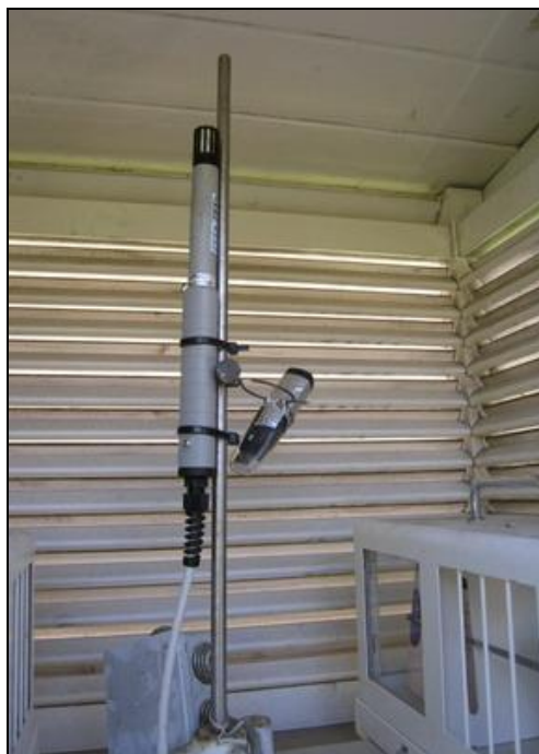
Slika 7: Položaj registratorja v meteorološki hišici in tipalo samodejne meteorološke postaje (Foto: I. SINJUR)
